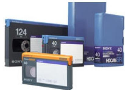
Als Weiterentwicklung von HDCAM kam 2003 HDCAM SR auf den Markt, wobei hier kein Komponentensignal (*YCrCb*) aufgezeichnet wird, sondern ein echtes RGB Bild mit der vollen Auflösung von 1920x1080 Pixeln. Es erfolgt keine (!) Farbunterabtastung – das Material wird 4:4:4 gespeichert. Dafür wird allerdings MPEG-4 zur Kompression der Daten verwendet. HDCAM SR ist dadurch sehr gut geeignet für Special Effects Aufnahmen (z.B. Greenscreen).
